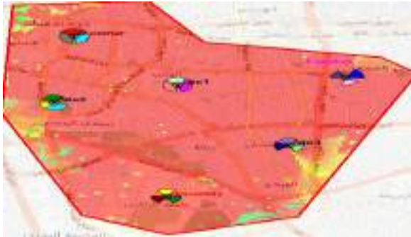
Fig4: gNodeB mapping scenario 1 SS-SINR parameter
